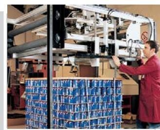
Le générateur de vide Moduflex est idéal pour être installé près des ventouses du robot. Applications : ouverture des boîtes, mise en boîte des produits, et transport des boîtes pleines.
