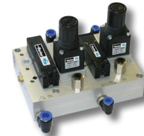
La platine d'alarme de gaz utilise un système maître/esclave avec l'oxygène comme gaz de contrôle. Si la pression du gaz de contrôle vient à manquer ou diminue, l'alimentation en N<sub>2</sub>O et/ou tout autre gaz asservi est immédiatement coupée. Dans le même temps, une alarme est activée afin d'alerter l'équipe médicale.
