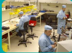
Cette installation respecte la norme ISO 14644-1, ISO Classe 6 (norme fédérale 209E, classe 1000) et possède sa propre zone de manipulation et de stockage du matériel dédié.
