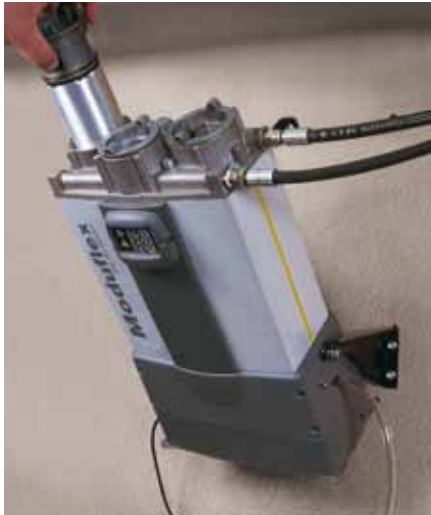
Kit de montage à basculement pour simplifier le remplacement de la cartouche.
