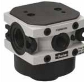
Les blocs offrent jusqu'à 2 orifices de sortie supplémentaires. Ils peuvent être raccordés à n'importe quelle position dans une configuration, par exemple en amont du lubrificateur pour disposer d'une prise d'air non lubrifié, ou encore en fin pour disposer d'orifices de sortie supplémentaires.
